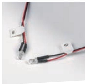
Для проверки работы светодиодов стоп-сигналов (маркировка «8») нажмите и удерживайте педаль тормоза (маркировка «7»). При нажатии на педаль оба светодиода должны загореться, а при отпуске погаснуть.
