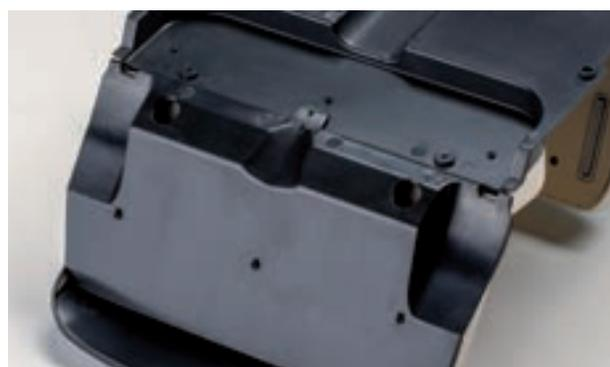
Поверх подушки, вдоль перегородки багажника установите спинку заднего сиденья. Закрепите ее с задней стороны перегородки тремя винтами 2,0×5 (LP). Обратите внимание: отверстия в наклонной части перегородки выполнены под острым углом к поверхности. Несмотря на это, крепежные винты спинки заднего сиденья необходимо закручивать строго перпендикулярно плоскости перегородки.
