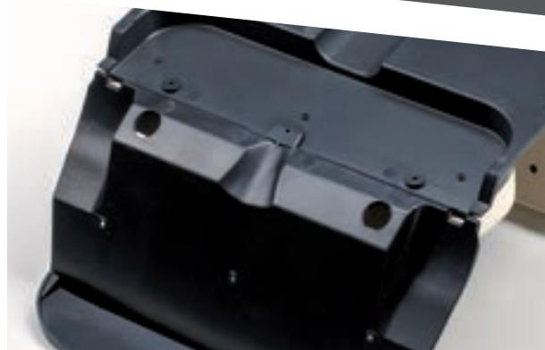
Перед перегородкой багажника установите на пол салона собранную ранее подушку заднего сиденья. Совместите крепежные отверстия подушки и пола. Закрепите детали с нижней стороны пола при помощи трех винтов 2,0×5 (LP).
