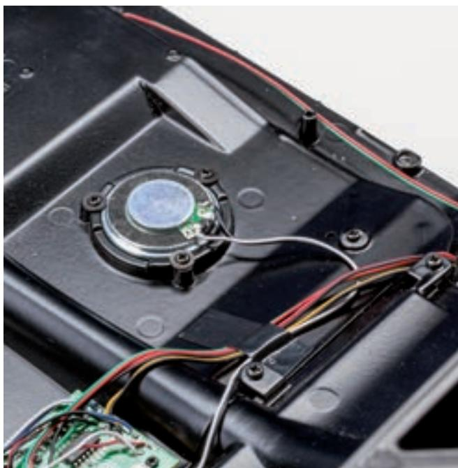
При нажатии на кнопку включения звукового сигнала (маркировка «3»), расположенную левее вала рулевой колонки, из динамика будет слышен звук, повторяющий звуковой сигнал прототипа. При отпускании кнопки сигнал прекратится.
